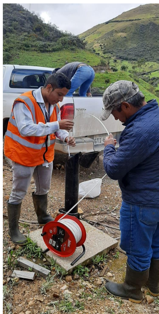
Foto 3. Medición del nivel freático con sonda de nivel.
